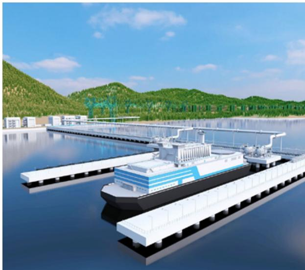
El casco tiene una longitud de 140 metros, un ancho de 30 metros y pesa 9549 toneladas. Cuando todos los equipos se instalen sobre el casco, el peso de la barcaza ascenderá a 19.088 toneladas. Se espera que el casco del buque se entregue a Rusia en 2023. Los equipos que llevará el mismo ya se están fabricando en las empresas de Atomenergomash, la división de construcción de maquinaria de Rosatom. La potencia eléctrica de la unidad flotante equipada con dos reactores será de 106 MW.
