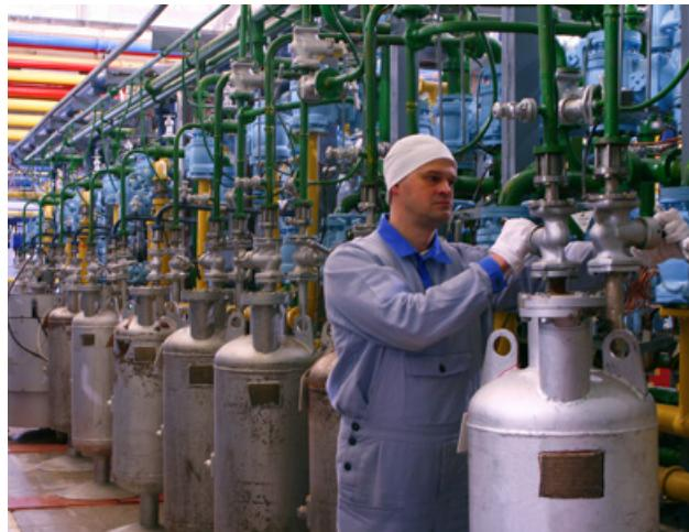
первый в разделительной отрасли технологический блок семиярусной компоновки, оснащенный газовыми центрифугами девятого поколения.
